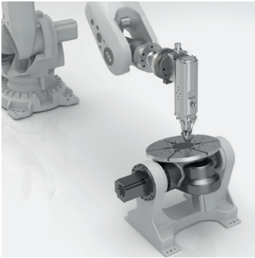
使用机器人和工作台进行焊接
